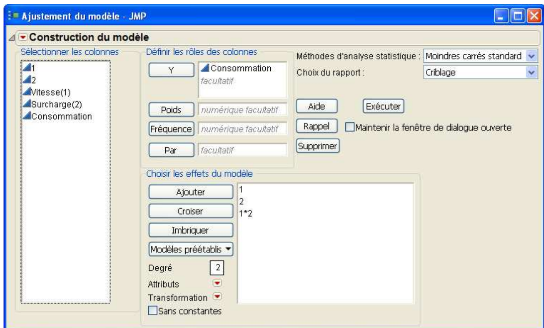
Figure 50 – Fenêtre "Ajustement du modèle" remplie et prête pour l'analyse (unités codées) de l'exemple "01_ma_voiture.jmp".
